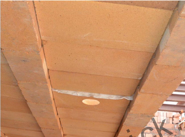
使用燃煤的隧道窑耐火砖上设有投煤孔，使用燃油的隧道窑烧嘴设在窑体侧面。
